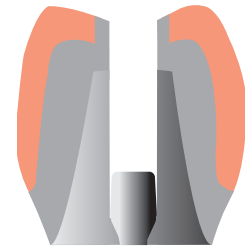
在氧化锆骨架上压铸的种植体
